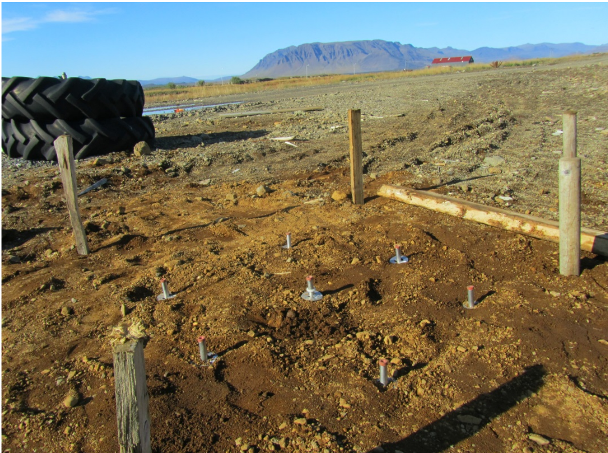
Mynd 3: Horft til norðurs yfir einn mælireit á rein 2, með sjö mislöngum mælirörum í yfirborðslagi reinarinnar (5 cm-120 cm). (Ljósmynd: Alexandra Kjeld.)
